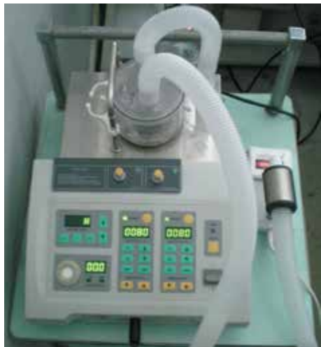
Рис. 1. Установка для сочетанного воздействия на область трофических язв низкоинтенсивного лазерного излучения, мелкодисперсного лекарственного орошения и микропневмомассажа
