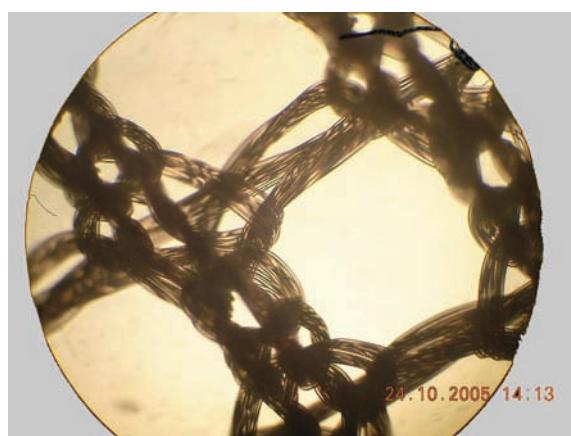
Рис. 1. Микрофотография плетения трикотажной салфетки из полиэфирного волокна. x 400.
